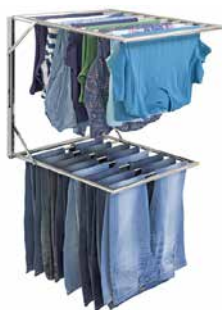
Torkställning John polerat rostfritt stål 10,1 m torklängd. BxDxH 600x52/260/560x630 mm. Placeras med överkant 1650 mm över färdigt golv
